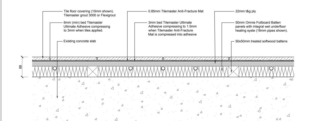
NEW UNDERFLOOR HEATING EXISTING GROUND FLOOR - TILE FINISH
